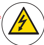
ОПАСНОСТЬ ПОРАЖЕНИЯ ЭЛЕКТРИЧЕСКИМ ТОКОМ
